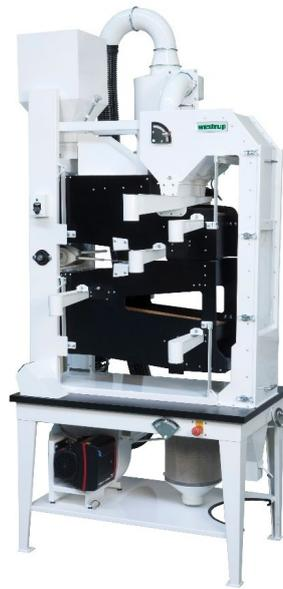
*Le nettoyeur-séparateur type LA-LSU de précision et finition pour utilisation laboratoire ainsi que pour une production à petite échelle dans les centres de recherche, les instituts etc.*
