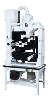
Der LA-LSU Luft/Siebreiniger ist ein Präzisions-/Feinreiniger für den Laborbetrieb sowie die Aufbereitung von Kleinpartien in Zucht- und Forschungsstationen, Instituten etc.
