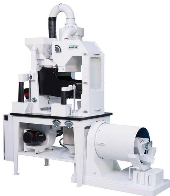
Le LA-LST peut être utilisé pour la séparation en batch et en flux continu et convient aussi parfaitement pour le nettoyage d'une grande diversité de types de semences.
